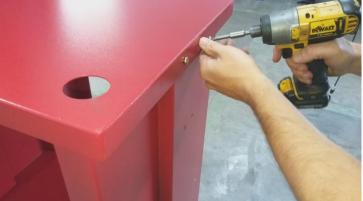
E por último o apoio de braço parafusado na tampa e nas laterais os apoios das cabeças.
