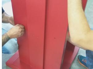
Coloque a tampa com o passador de fios virado para trás e parafuse
