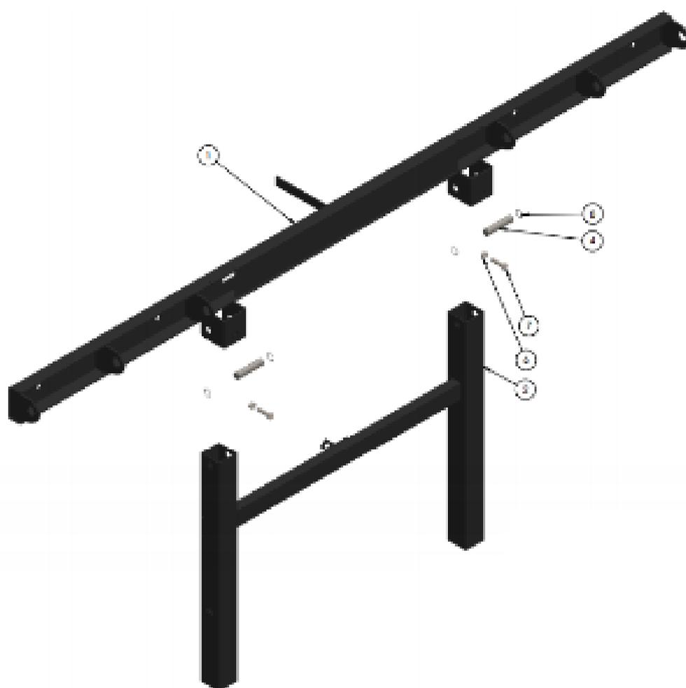
Em seguida coloque os pistões pneumáticos em suas posições, como mostra o desenho acima.
