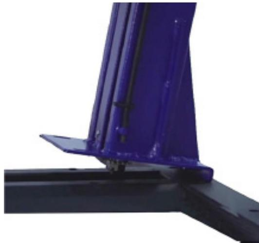
Após a montagem das colunas, é feito o ajuste da tensão da corrente através do parafuso lateral ao pé da coluna. Lembre-se de afrouxar os parafusos que prendem a coluna à base.
