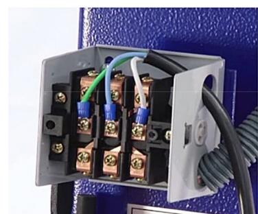
O esquema de ligação à rede elétrica, é o mesmo para os elevadores trifásico ER2500 e ER4000, lembrando que para o modelo de 4t, como possui dois motores, o chicote de energia que passa pela base, também deve ser conectado de acordo com as cores correspondente nas duas pontas.
