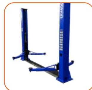
Devido à sua natureza hidráulica, esta linha de elevadores exige baixa manutenção, eliminando a necessidade de reposição de óleo ou graxa graças ao seu sistema autolubrificante. Isso não apenas reduz a necessidade de interrupções operacionais, mas também prolonga a vida útil do equipamento.
